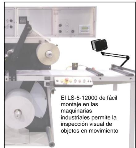
El LS-5-12000 de fácil montaje en las maquinarias industriales permite la inspección visual de objetos en movimiento
