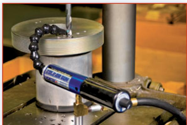
Las pistolas de aire frío Vortec utilizan aire comprimido filtrado y tecnología de tubo de vórtice para producir aire bajo cero para aplicaciones industriales de enfriamiento por puntos. Sin partes móviles que se desgasten, el tubo de vórtice interno convierte el aire comprimido en una corriente de aire frío, produciendo temperaturas de hasta -30 F (-34 C).
