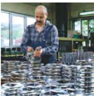
Montaje final de los chucks de seguridad Boschert.
