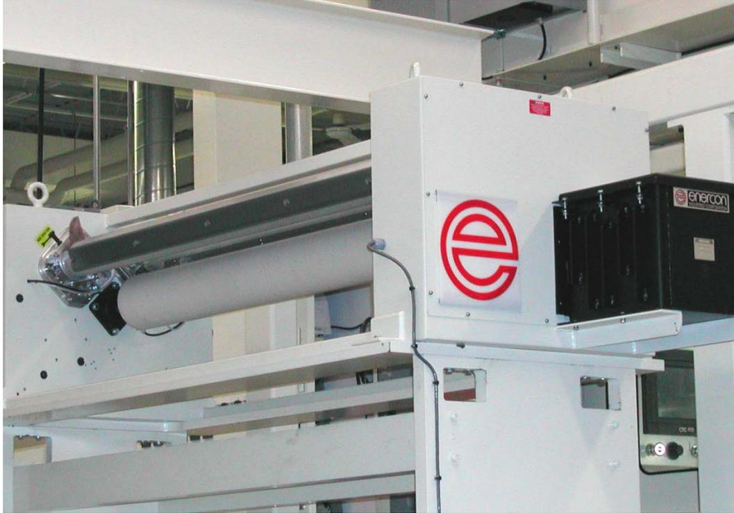
Corona es aire ionizado creado en el espacio de aire entre los electrodos y el rodillo a tierra.
