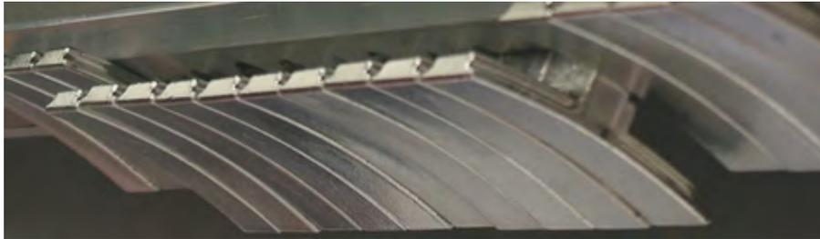
← **Electrodos Segmentados** son usados para aplicaciones donde el tratamiento de línea o ancho variable es requerido.
