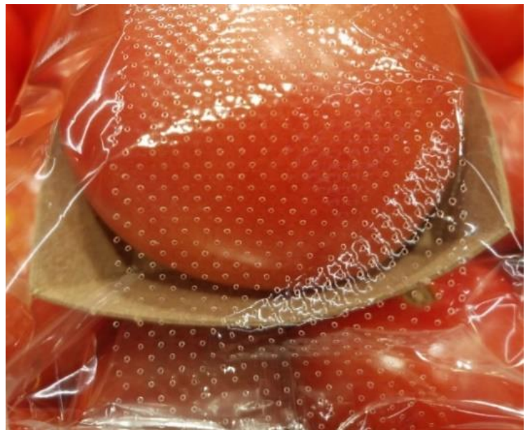
Perforación con puntas calientes para drenaje y ventilación.
