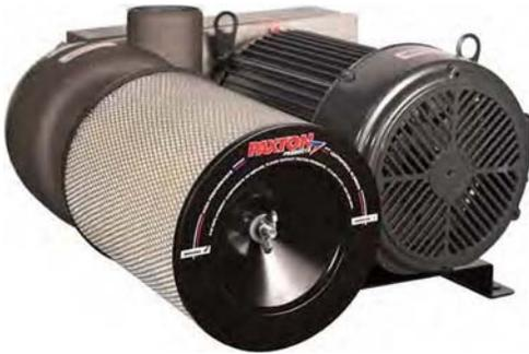
Soplador centrífugo Paxton serie at es compacto y eficaz pesa menos de 30lb. (13.6kg) sin motor y brindan corrientes de aire de 2,400cfm, presión de 130 pulgadas h2o y un vacío de 100 pulgadas h2o(g) para un verdadero alto rendimiento. Se logran velocidades de aire hasta 40,000 pies por minuto (12,92 km/min) reducen el calor, el ruido y la vibración, consume menos energía.
