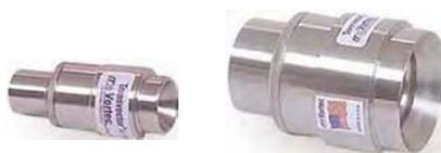
Los transvectors usan el principio del impulso para obtener corrientes de aire amplificadas. Cuando el aire comprimido entra en el transvector, llena una cámara con un sólo patrón de salida, un orificio anular de 0.002" (0.051 mm). Como el aire es forzado a salir por el orificio, esto acelera y choca con el aire que entra en gran volumen del ambiente. El resultado es un gran volumen de salida de aire al introducir una pequeña cantidad de aire comprimido.
